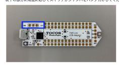
前述の使用例 B で使用する場合は以下の部分 2 カ所に 14P ピンヘッダを ハンダ付けしてください。
