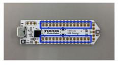
前述の使用例 C で使用する場合は以下の部分に 5P ピンヘッダを ハンダ付けしてください。
