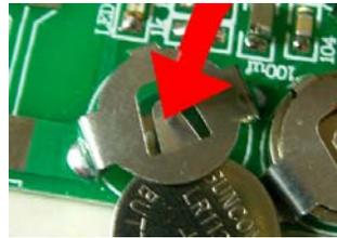
接触不良やボタン電池がはずれやすい場合はこの板バネを押してください。注意:接触不良の場合は動作しません。
