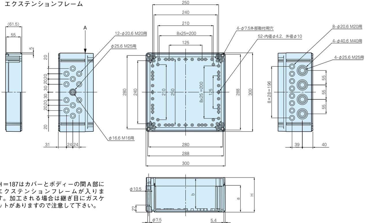
● H=187はカバーとボディの間A部にエクステンションフレームが入りません。加工される場合は継ぎ目にガスケットがありますので注意して下さい。
