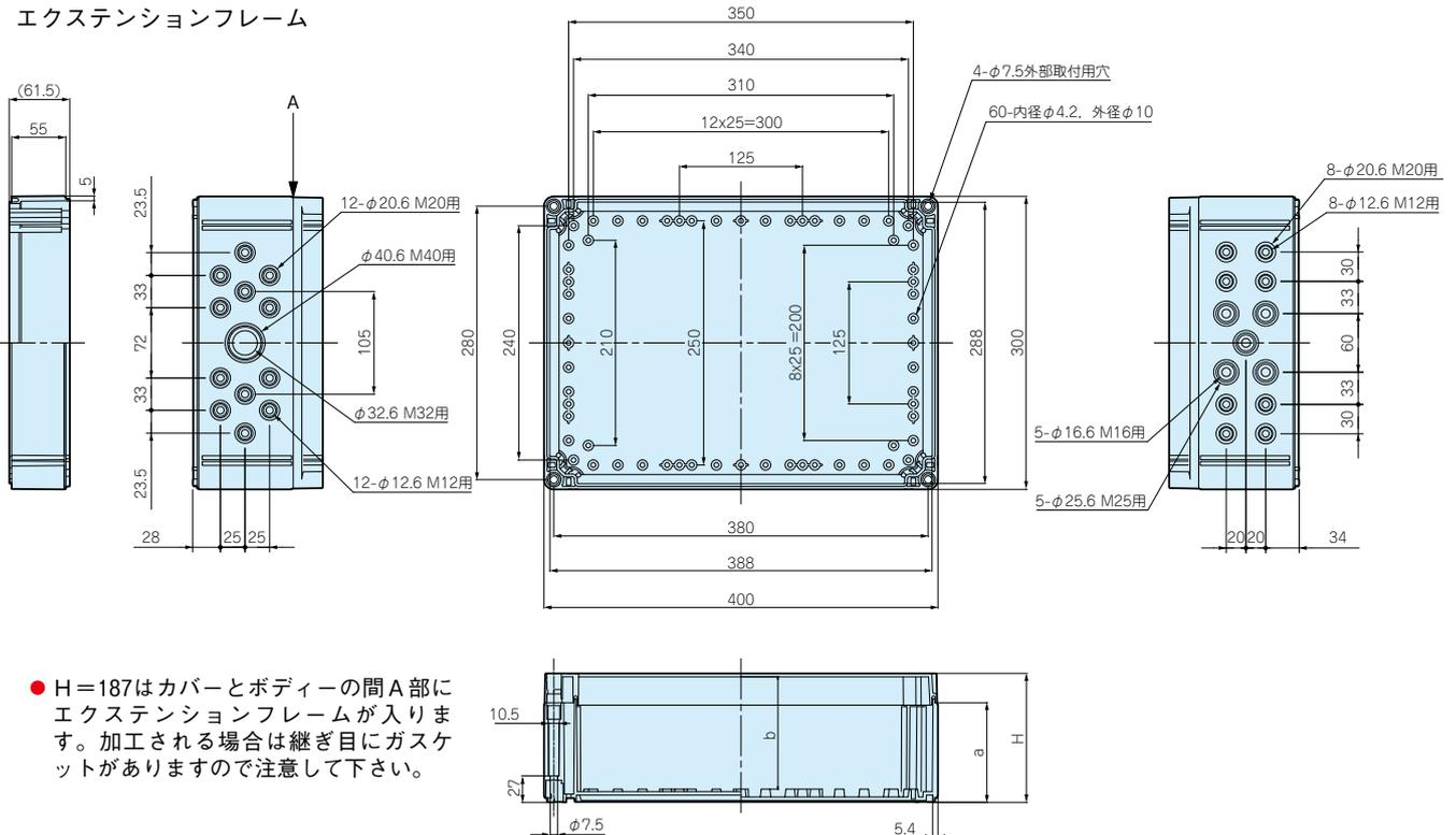
● H=187はカバーとボディの間A部にエクステンションフレームが入りません。加工される場合は継ぎ目にガスケットがありますので注意して下さい。
