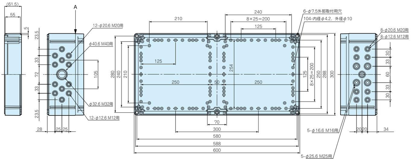
● H=187はカバーとボディーの間A部にエクステンションフレームが入ります。加工される場合は継ぎ目にガスケットがありますので注意して下さい。
